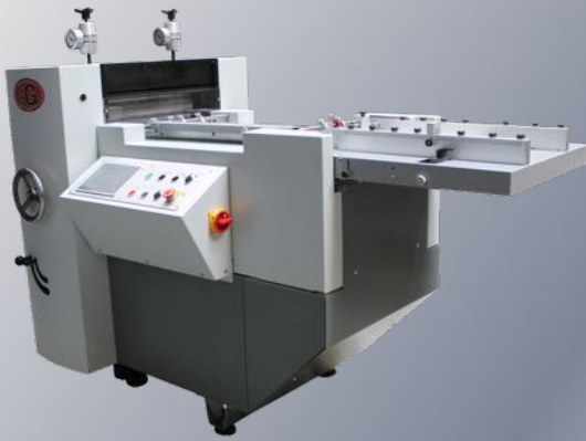
Chargeur à paquette pour les petits tirages
